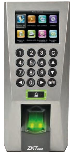
F18 es un innovador lector biométrico de huellas dactilares para aplicaciones de control de acceso. Con compacto diseño y un firmware que permite funciones de alto rendimiento, se ha convertido en uno de los dispositivos más populares de ZKTeco.
