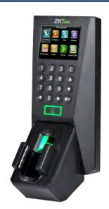
FV18 es un lector multi-biométrico capaz de capturar y procesar las venas de los dedos y las huellas digitales al mismo tiempo. La nueva plataforma de hardware utiliza una core-board ZMM220 con 1.2Ghz CPU.
